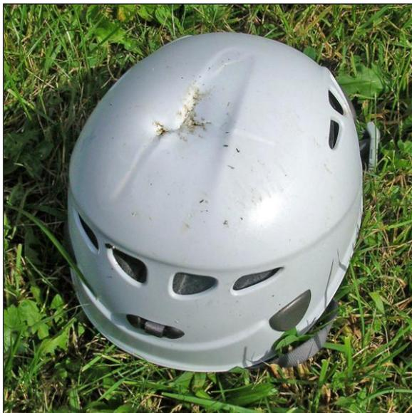
L'impact de la pierre sur le casque est bien visible sur la coque extérieure de l'Elios PETZL
