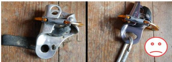
mousqueton de taille normal type "spirit", il est plus que conseillé de frapper le mousqueton de longe dans le trou supérieur (c'est ce qui était
