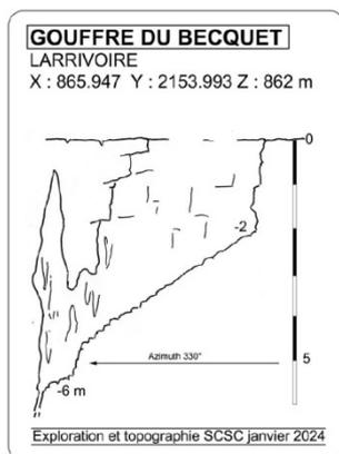
Bel orifice rectangulaire de 3 m par 1,5 m suivi d'un cran vertical de 2 m. Un tronçon de couloir en pente raide conduit au point bas à -6 m au pied d'une petite cheminée. Le terminus ressemble à une tête de puits comblé par des pierrailles.
