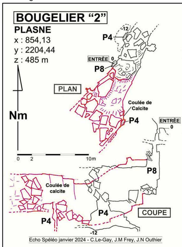
Cette fois, c'est au sud de cette zone que nous accédons par un puits de 8 m dans une faille de bonnes dimensions (4 x 3 m) rapidement comblée de blocs ne permettant pas de progression au-delà – trop dangereux – Profondeur 12 m
